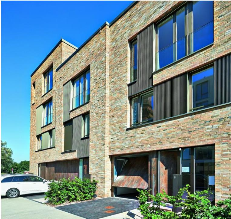
**Bild 2:** Das Sammelgaragentor ET 500 von Hörmann kann bauseitig beplankt werden und integriert sich somit in die Fassade des Gebäudes.
